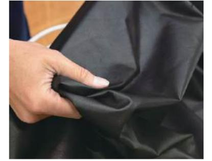
いきますので、もちろん革の強度自体も下がってしまいます。この革は、鞣し後に行うシエーピングという革の厚さを整える作業でここまで薄くしています。そのため、最低限の堅牢性を保ちつつ軽い革に仕上げることができました。また、今までソフト系の革で様々な素上げの革を作ってきましたが、今までの経験を生かし、さらに軽さだけを突出させた新しい商品になります。この革も同じ素上げで作られた革なので、手に吸い付くようなタッチ感と柔らかさも兼ね備えた革になります。
